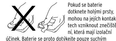
Pokud se baterie dotknete holými prsty, mohou na jejich kontaktech vzniknout znečištění, která mají izolační účinek. Baterie se proto dotýkejte pouze suchým měkkým hadříkem.
